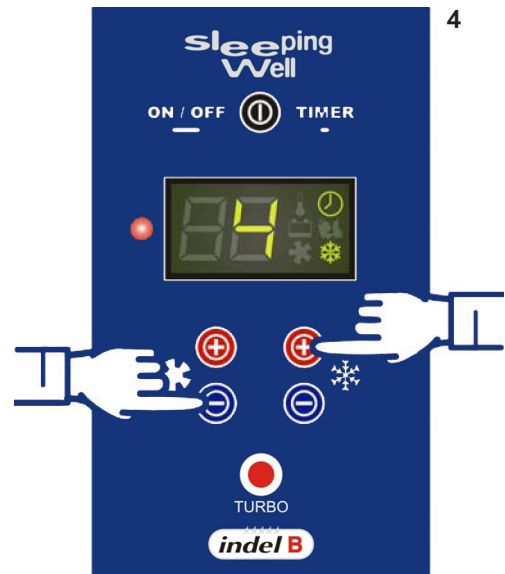
4 VARIAZIONE TIMER IN MODALITÀ DI FUNZIONAMENTO TURBO TIMER ADJUSTMENT IN TURBO MODE VARIATION TIMER EN MODALITÉ TURBO EINSTELLUNG TIMER IN DER BETRIEBSART TURBO VARIACIÓN DEL TEMPORIZADOR EN MODALIDAD TURBO
